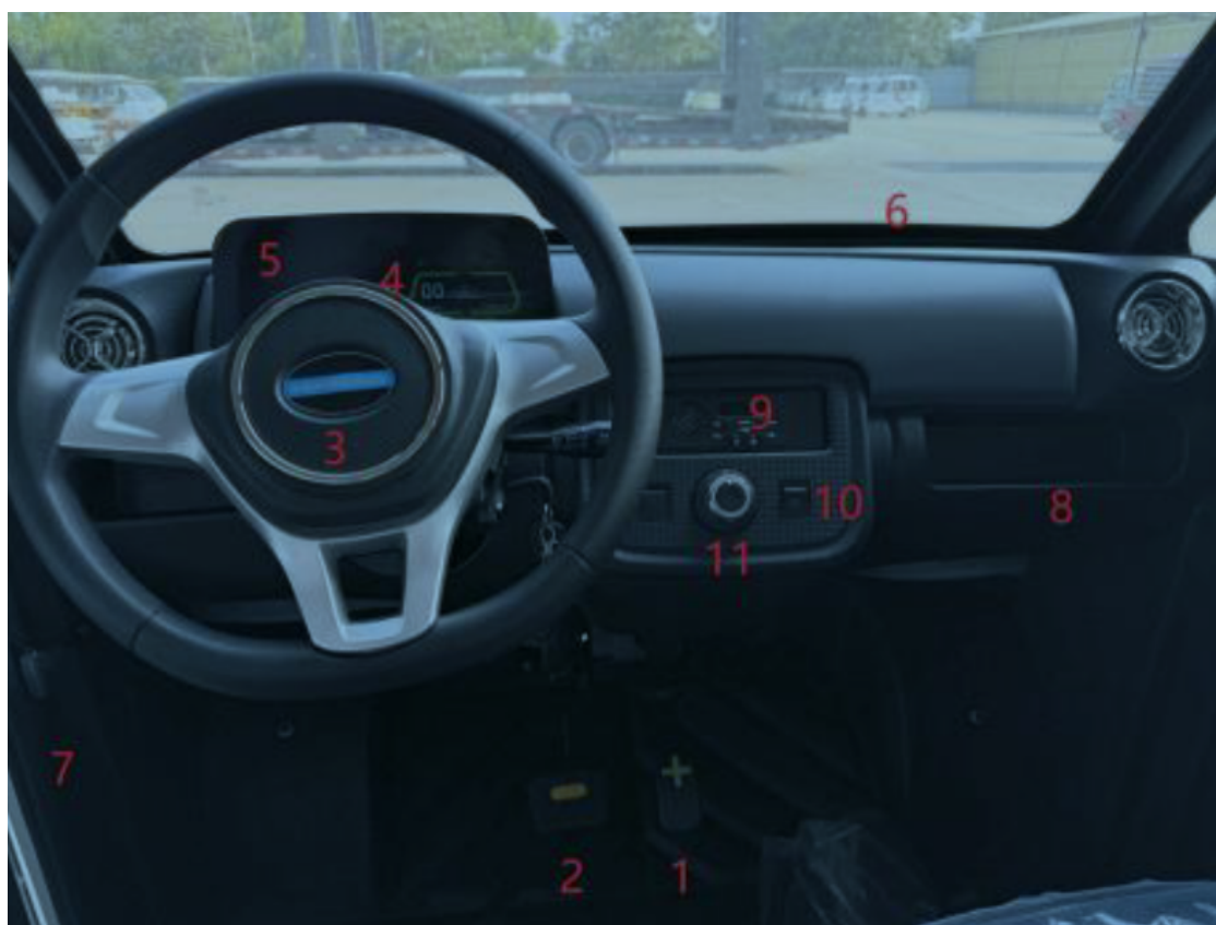
FIGURE 1 – Poste de conduite avec identification des commandes
